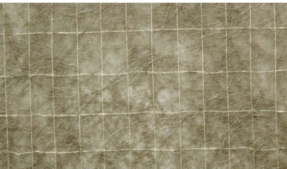
impregnovaná kombinovaná vložka z polyesterové rohože vyztužené mřížkou ze skleněných vláken, 175 g/m 2
